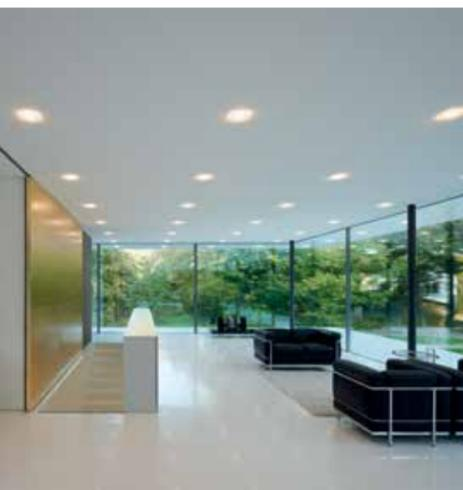
Die großzügigen Fensterfronten spielen auch eine wesentliche Rolle für die Maximierung der Energiegewinnung: 66 Prozent des gesamten Heizwärmebedarfs werden durch passive solare Gewinne gedeckt.
